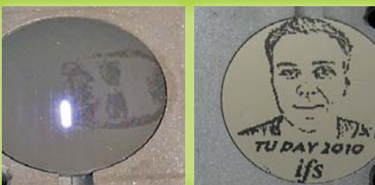
Laserbearbeitung: Pro Sekunde scannt der Laser ca. 370 Pixel der Bilddatei ab (links). Rechts: der fertige Einkaufswagenchip
